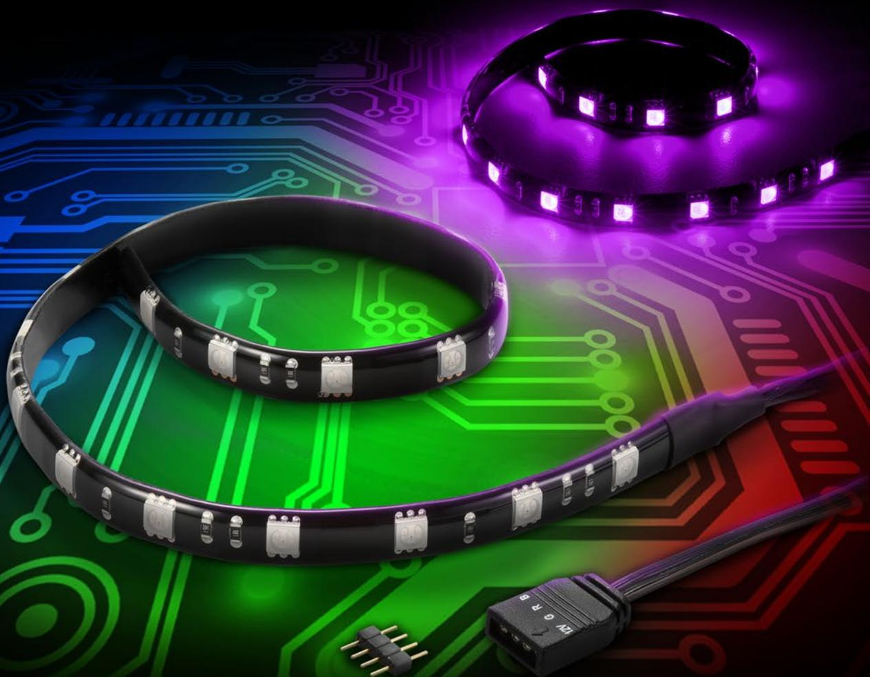
Гибкая светодиодная полоска Pacelight RGB имеет 18 светодиодов длиной 360 мм, что делает ее идеальной для придания яркости корпусу. Специально разработанная для контроллера Pacelight она также совместима с другими контроллерами RGB с соединением 12V-G-R-B. Полоска может быть установлена с помощью самоклеящейся поверхности или с помощью магнитного крепления.
